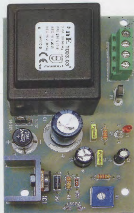
Fig.5 Schema elettrico dello stadio alimentatore già pubblicato nella rivista N.174 con la sigla LX.1174 e da noi rinominato LX.1174/24. Per adattarlo alle nuove esigenze abbiamo modificato i valori delle resistenze R1-R2 e sostituito il trasformatore T1. Sotto, elenco componenti aggiornato e foto del montaggio.
