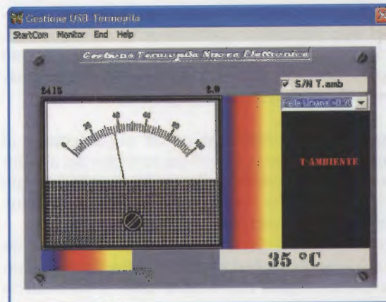
Fig.41 Sopra lo strumento virtuale compariranno il valore binario registrato dal convertitore A/D ed il valore di tensione in Volt corrispondente alla temperatura visualizzata nel riquadro in basso a destra.
