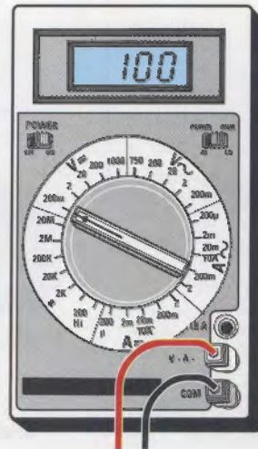
Fig.20 Per tarare le altre due portate dei 10-1 millihenry commutate il tester sulla portata 200 millivolt. Inserite nella morsettiere una impedenza da 1 millihenry che corrispondono a 100 microhenry, quindi ruotate il trimmer R6 fino a far apparire il numero 100.
