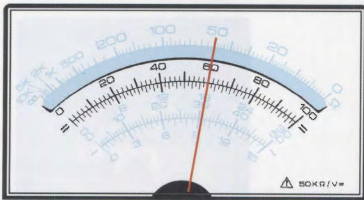
Fig.9 Anche se sul quadrante del Tester sono presenti più scale graduate, per ottenere una lettura semplificata consigliamo di adottare la scala graduata da 0 a 100.
