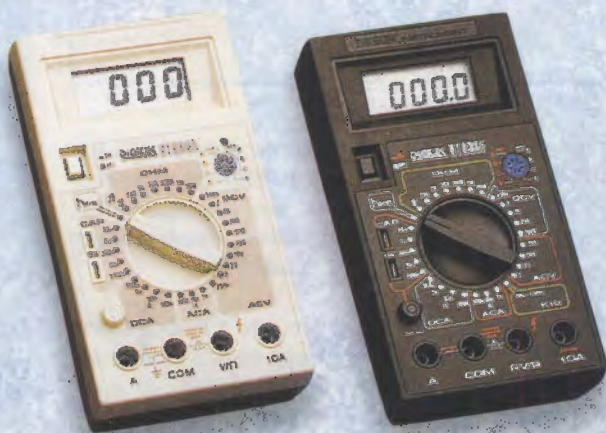
Fig.1 Se il vostro tester, Analogico o Digitale, non riesce a leggere frequenze superiori a 500 Hz, realizzando questo kit noterete che riuscirà a leggere frequenze fino a 30.000 Hertz e con una impedenza d'ingresso di ben 1 Megaohm.
